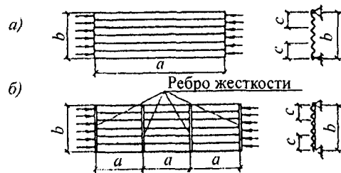
а – без поперечных ребер жесткости; б – с поперечными ребрами жесткости
